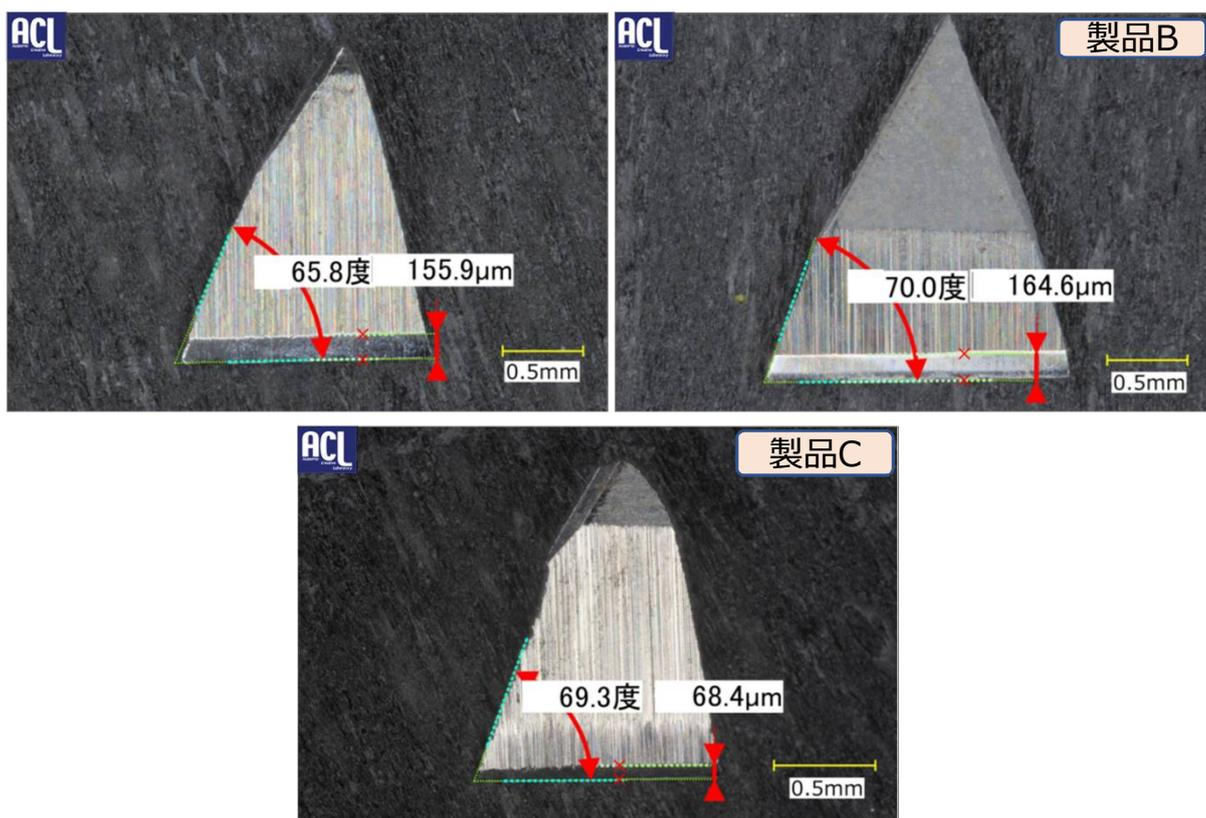
写真に示しました製品A,B,Cの観察・計測結果のように、拡大観察・計測により3製品の違いが数値化できました。
