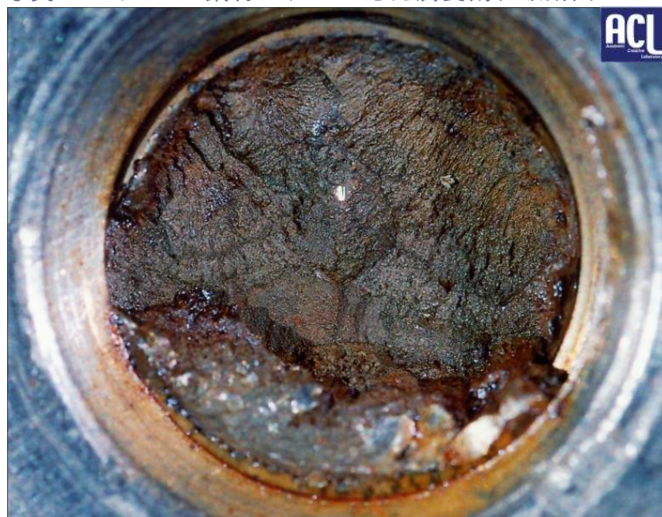
写真1 ステンレス鋼材シャフトの応力腐食割れ破断面
