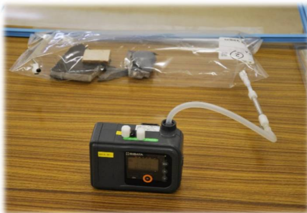
建材から発生している揮発成分捕集状況
