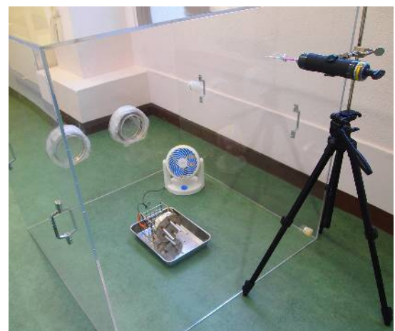
脱臭性能試験 ブランク試験状況
