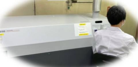
ICP発光分光装置 (ICP-AES法)
