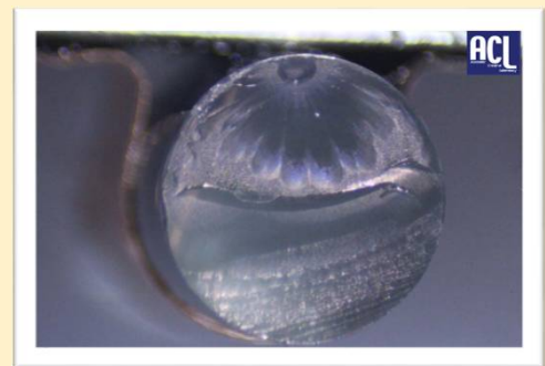
ポリカーボネート(PC)の破面
