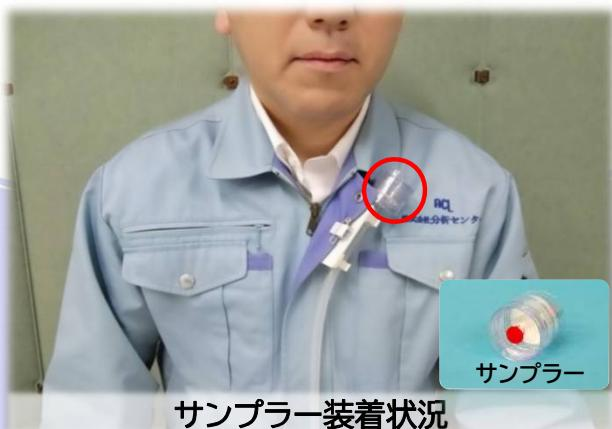
サンプラー(メンブランフィルター)を作業者の呼吸域付近に装着し、空気中の酸化カルシウムを採取します。サンプラーに採取した酸化カルシウムを酸による加熱溶解後、ICP発光分光分析装置を用いて測定します。
