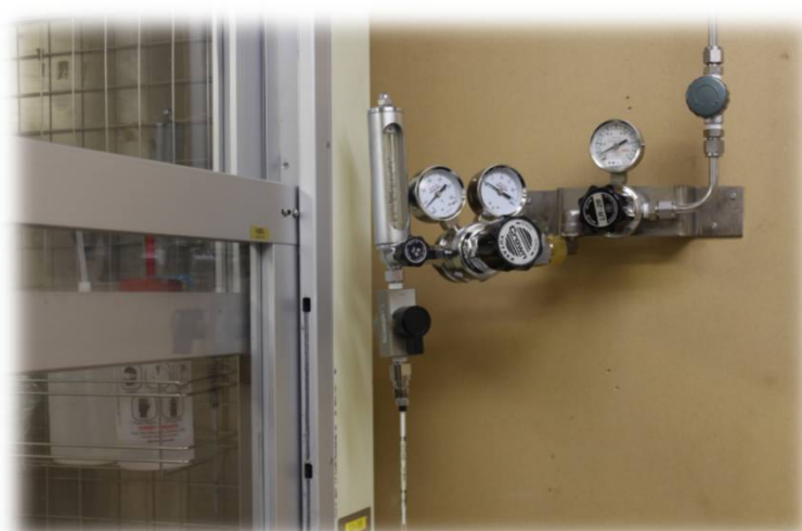
写真：圧縮空気配管内の流体中のオイルミスト計測風景
