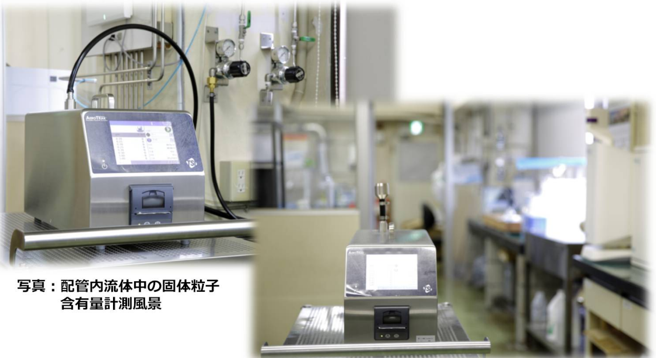
写真：クリーンルーム室内空気中の 固体粒子含有量計測風景
