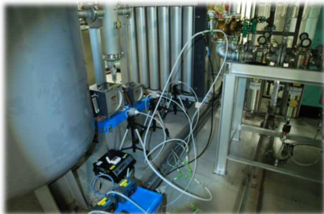
写真：圧縮空気中の液状オイル、オイルミスト、粒子の測定状況
