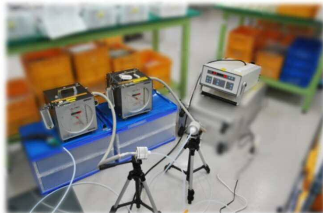
写真：圧縮空気中の液状オイル、オイルミスト、粒子の測定状況
