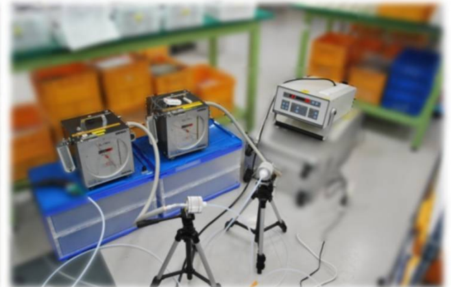
写真 : 圧縮空気中の液状オイル、オイルミスト、粒子の測定状況
