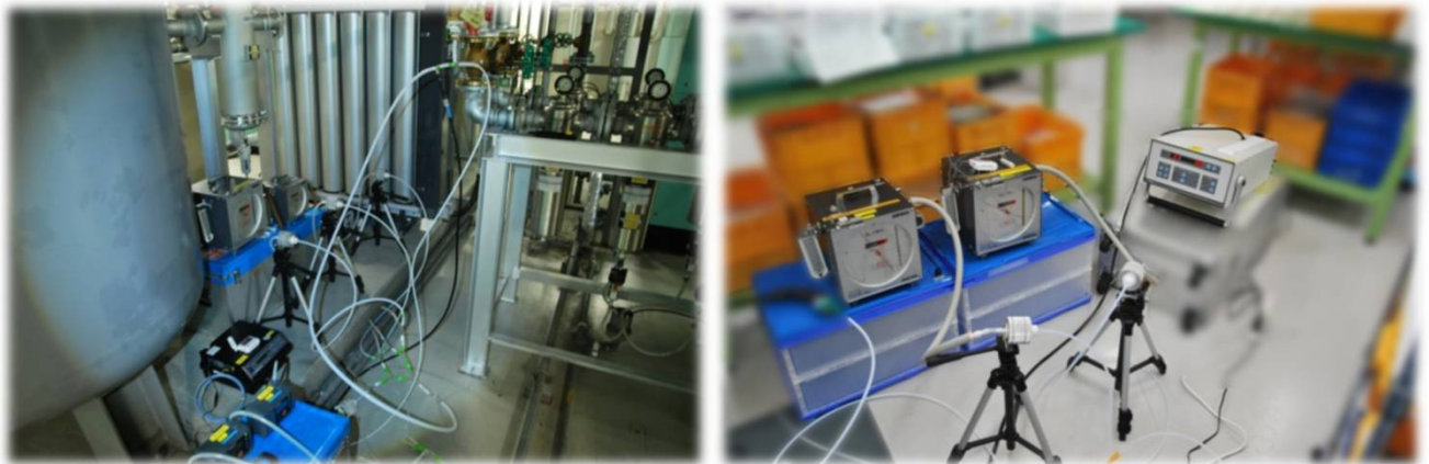
写真 : 圧縮空気中の液状オイル, オイルミスト、粒子の測定状況
